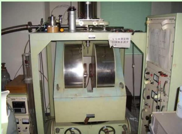
**振動試料型磁力計:**
