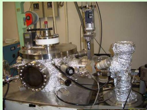
**熱処理装置:**  $10^{-6} - 10^{-5}$  Pa 台の高真空中でSi基板(20mm□程度)などの熱処理が可能です。最高温度は600°Cです。
